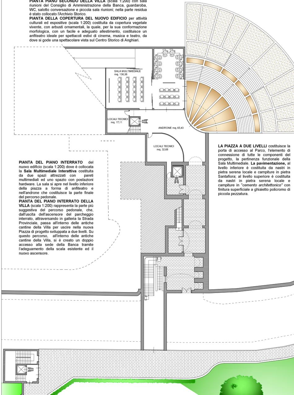
**PIANTA DEL PIANO INTERRATO** del nuovo edificio (scala 1:200) dove è collocata la Sala Multimediale Interattiva costituita da due spazi attrezzati con pareti multimediali ed uno spazio con postazioni hardware. La sala si apre nel livello inferiore della piazza a forma di anfiteatro e nell'androne che costituisce la parte finale del percorso pedonale.
