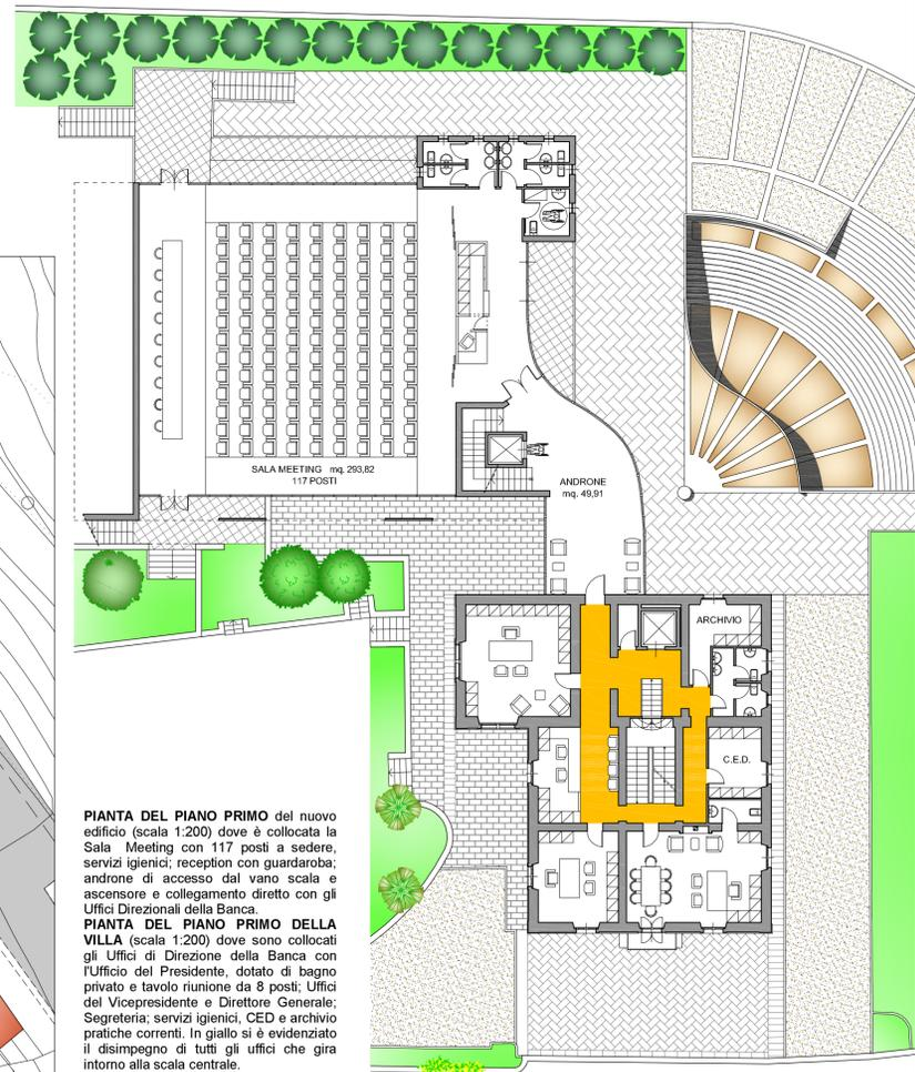
**PIANTA DEL PIANO PRIMO** del nuovo edificio (scala 1:200) dove è collocata la Sala Meeting con 117 posti a sedere, servizi igienici; reception con guardaroba; androne di accesso dal vano scala e ascensore e collegamento diretto con gli Uffici Direzionali della Banca.
