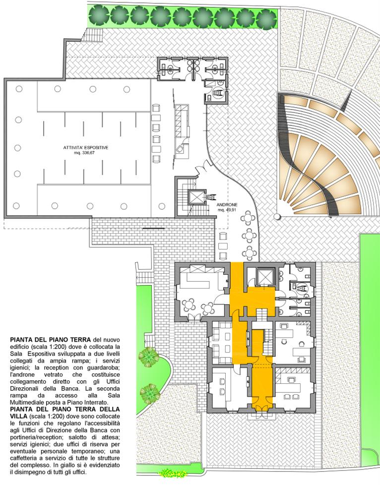
**PIANTA DEL PIANO TERRA** del nuovo edificio (scala 1:200) dove è collocata la Sala Espositiva sviluppata a due livelli collegati da ampia rampa; i servizi igienici; la reception con guardaroba; l'androne vetrato che costituisce collegamento diretto con gli Uffici Direzionali della Banca. La seconda rampa da accesso alla Sala Multimediale posta a Piano Interrato.
